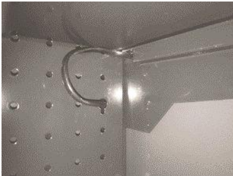
Abb. 9: Das Kabel in Geräterückwand verlegen
